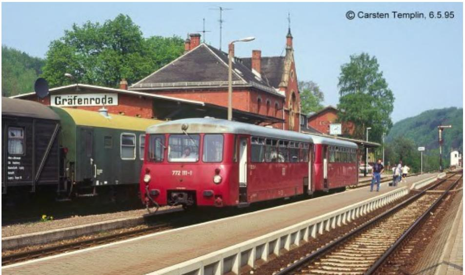
*Der Bahnhof Gräfenroda hatte 1989 noch mechanische Signaltechnik und ebenerdige Bahnsteigzugänge. Auf seine aufwändige Modernisierung hätte man durch den Neubau 2 km weiter südlich verzichten können.*
