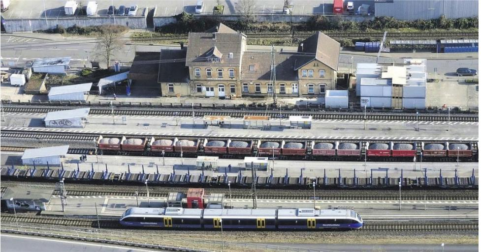
Blick auf den Bahnhof Brackwede aus der Vogelperspektive nach Osten: Jedes der 6 Gleise hat einen Bahnsteig, zur Expo 2000 wurde aber nur der für den Haller Willem zwischen den Gleisen 5 und 6 modernisiert. Die beiden anderen Bahnsteige und die Unterführung folgten erst 2019 / 2020. (© Detlef Wittig)
